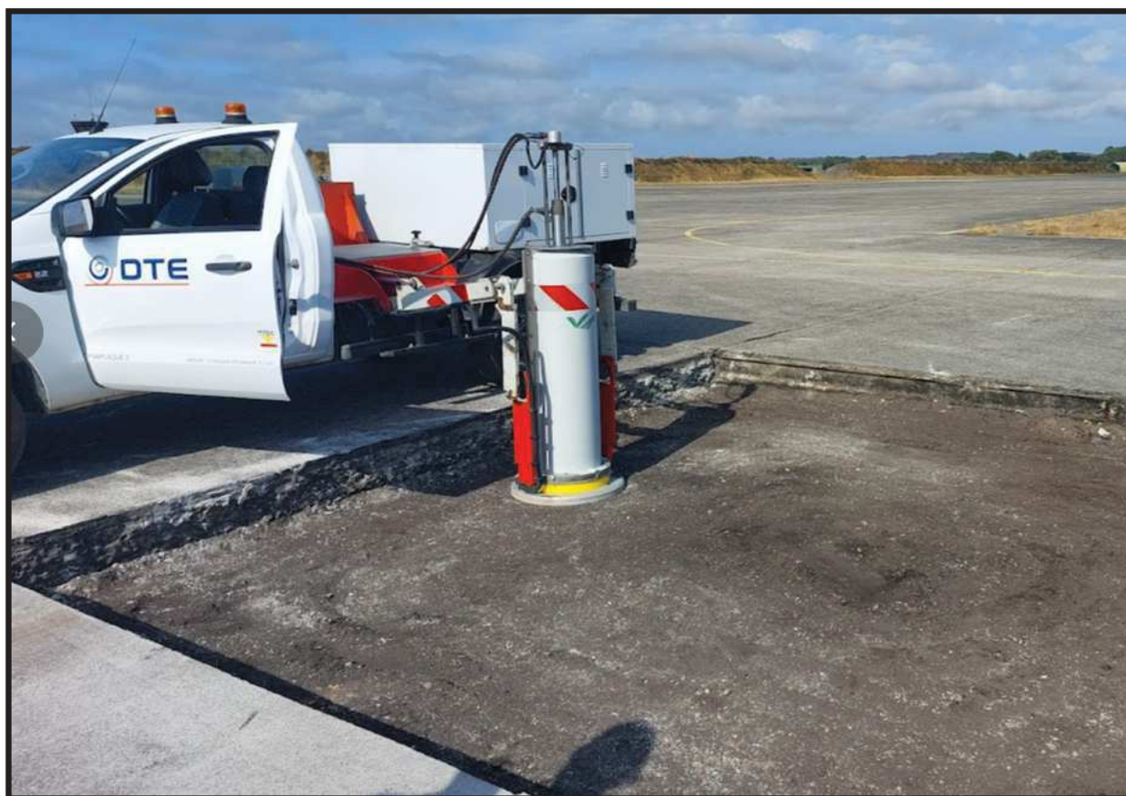
Photo 2: Essais de portance à la dynaplaque
